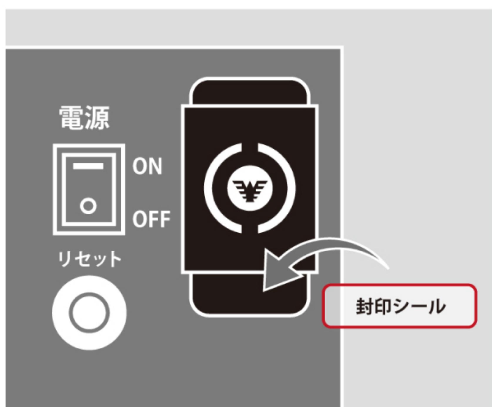
設定キーが回ることが確認できましたら本体・アタッチメントを両面テープでしっかりと固定し、最後に封印シールを貼って取り付け完了です。
