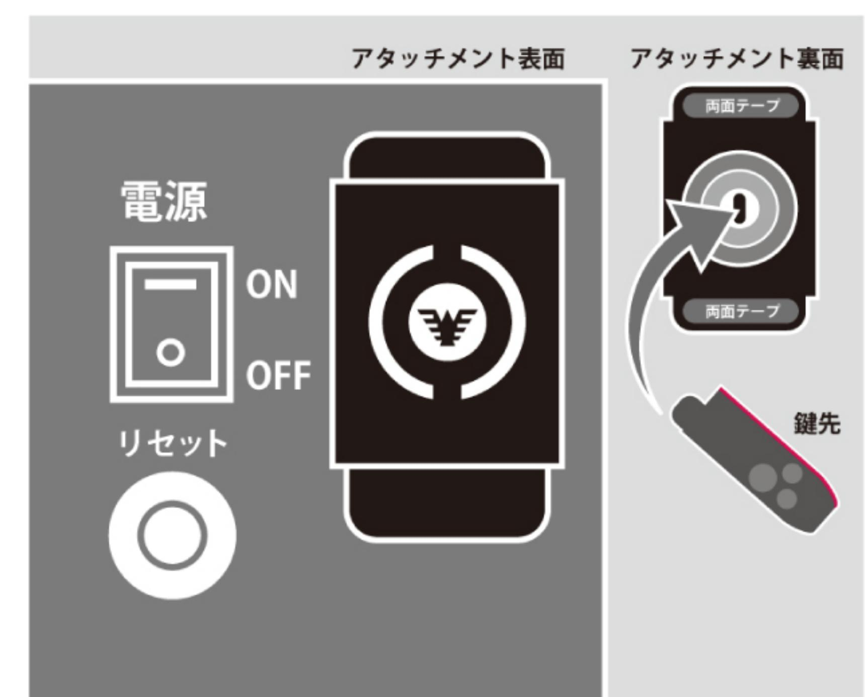
続いて鍵先の上から、本体アタッチメントを取り付けますが、両面テープで固定する前に手持ちキーで設定キーが回るかを確認してください。
